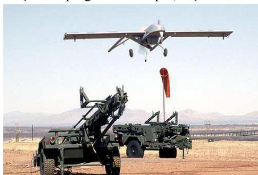
*Fig. 1.45. Lansare hidraulică*
