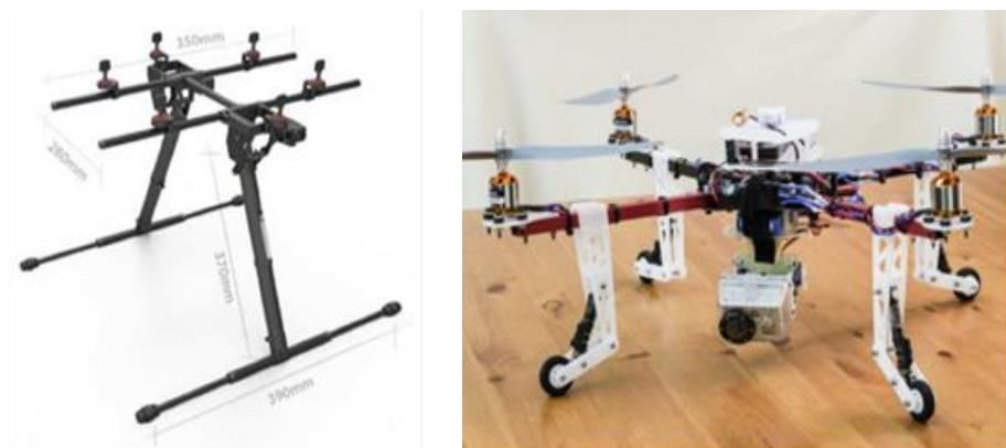
*Fig. 1.16. Unelte de aterizare*
