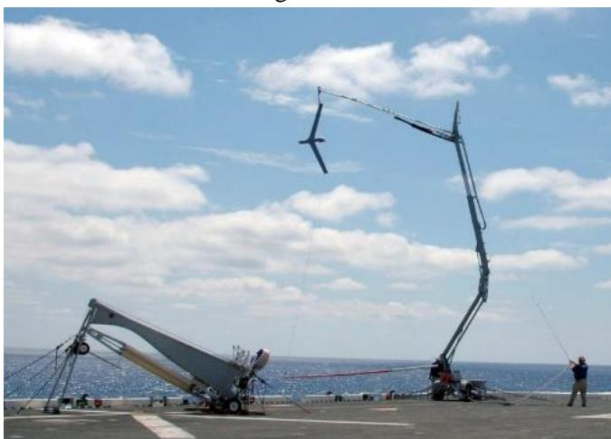
Fig. 1.1.50. Recuperarea UAV-ului ScanEagle prin metoda Skyhook
