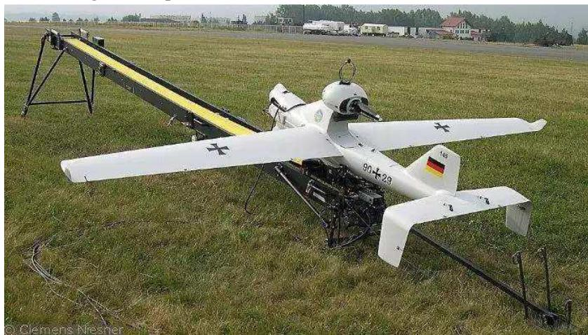
*Fig. 1.1.44. UAV-ul LUNA lansat de pe o catapultă cu coardă de bungee*
