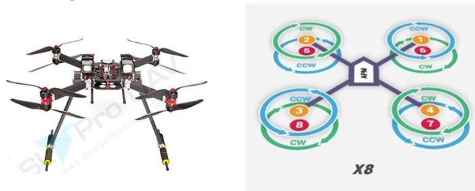
*Fig. 1.1.13. Octocopter. Configurația X8*
