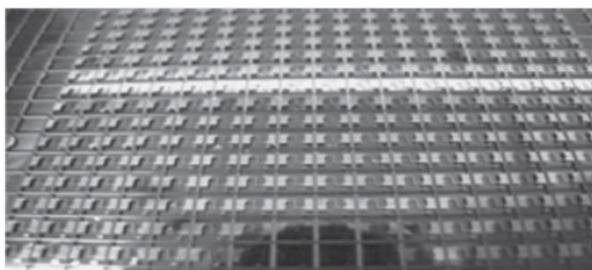
*Fig. 1.4.10. Suprafață acoperită de senzori MEMS de căldură*
