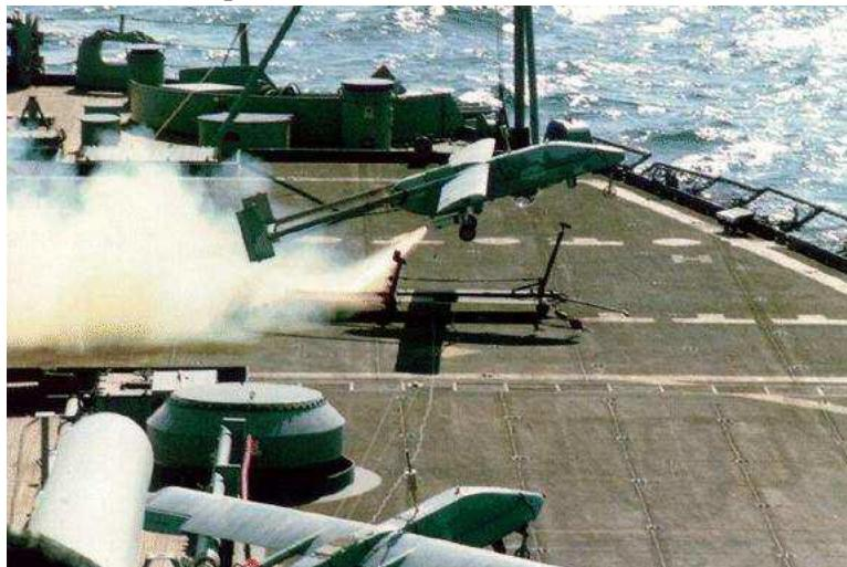
*Fig. 1.1.43. UAV-ul Pioneer lansat cu ajutorul sistemului RATO*
