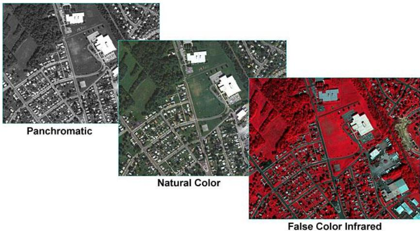
Fig. 1.3.27 Tipuri de imaginiale camerei Leica ADS-40
