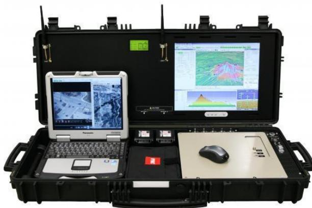
*Fig. 1.1.28. Stația de control la sol*
