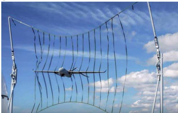
*Fig. 1.1.48. Recuperarea cu plasă a UAV-ului Pioneer*
