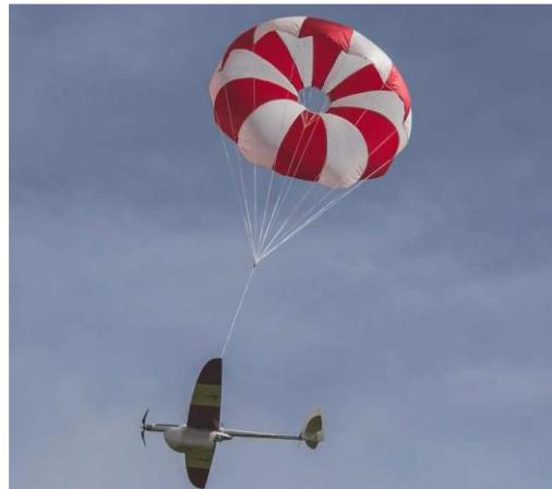
*Fig. 1.1.47. UAV-ul Exdrone ridicat de parașută*
